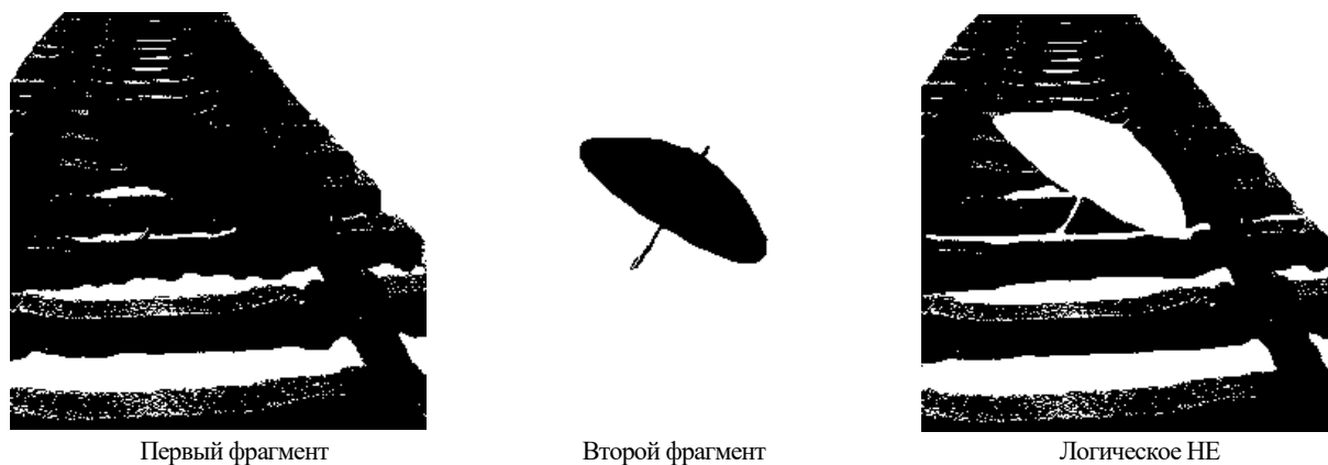
Рис. 3. Применение логического НЕ Fig. 3. Application of the logical NOT
