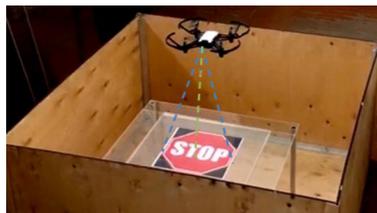
Рис. 12. Автоматическая посадка дрона с распознаванием изображения Fig. 12. Automatic drone landing with image recognition
