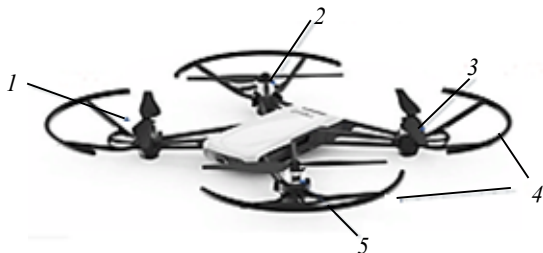
Рис. 6. Дрон DJI RYZE TELLO: 1 – двигатель 1 (вращается против часовой стрелки); 2 – двигатель 2 (вращается по часовой стрелке); 3 – двигатель 3 (вращается против часовой стрелки); 4 – защита пропеллера; 5 – двигатель 4 (вращается по часовой стрелке)
