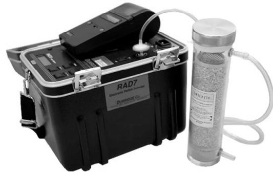
Рис. 6. Измерительный комплекс «RAD 7»
