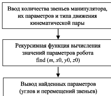
Рис. 5. Алгоритм решения обратной задачи кинематики Fig. 5. Algorithm for solving the inverse problem of kinematics
