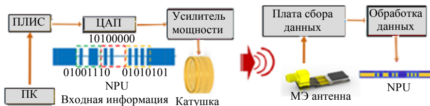
Рис. 12. Демонстрация работы магнитоэлектрической антенны, принимающей сигнал магнитного поля, содержащий информацию. ПЛИС – программируемая логическая интегральная схема; ЦАП – цифро-аналоговый преобразователь [39]
