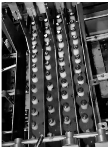
Рис. 5. Разделение потока продукта на 4 ручья Fig. 5. Collating product flow on 4 streams
