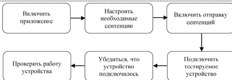
Рис. 2. Схема работы с симулятором эхолота
