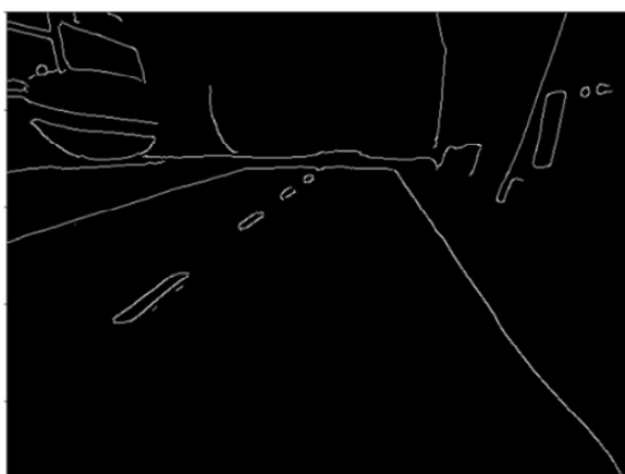
Рис. 8. Пример поиска границ на изображении с помощью алгоритма «детектор границ Кенни»
