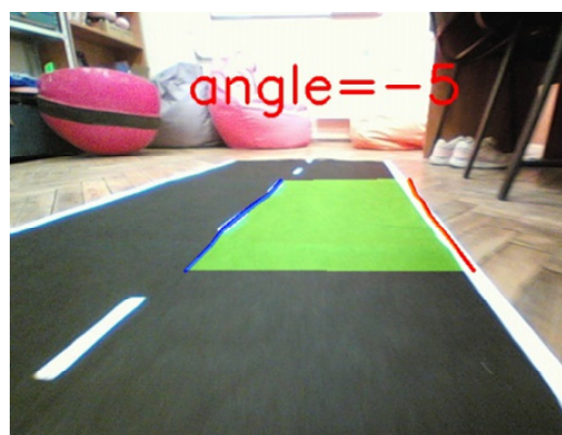
Рис. 10. Представление кадра с распознанными полосами разметки и заданием угла поворота рулевого привода на 5^\circ вправо
