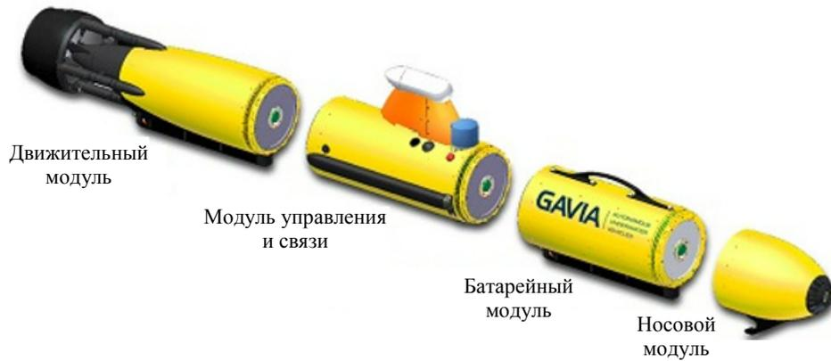
Рис. 3. Модульный состав аппарата GAVIA
