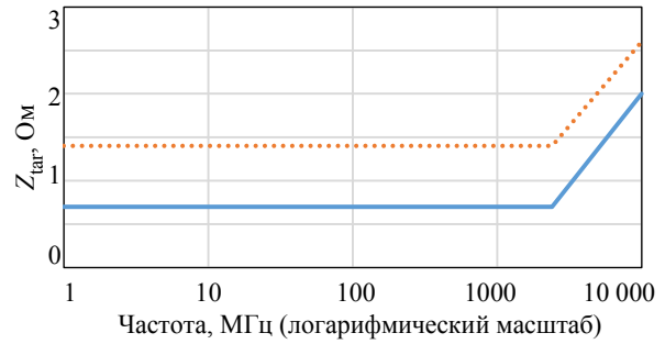
Рис. 3. Зависимость значения целевого импеданса от частоты Fig. 3. Target impedance versus frequency
