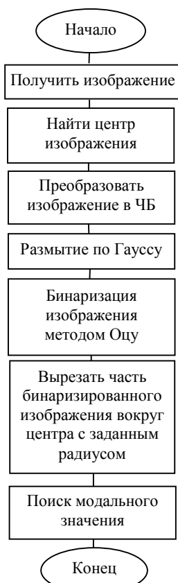
Рис. 15. Общий алгоритм определения цвета клетки Fig. 15. General algorithm for determining the square color
