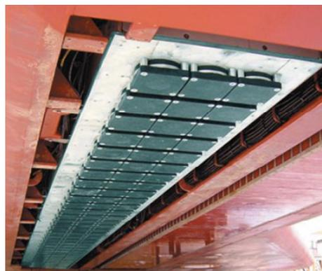
Рис. 3. Пример установки матрицы преобразователей ПГ «SBP 29»
