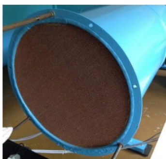
Рис. 3. Аэродинамическая труба: а – форкамера; б – схема форкамеры Fig. 3. View (a) and diagram (b) of the wind tunnel pre-chamber
