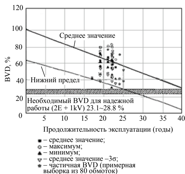
Рис. 2. Корреляция между BVD и продолжительностью эксплуатации большого количества электрических машин [15]
