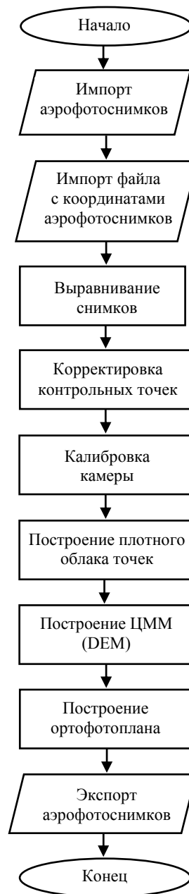
Рис. 1. Алгоритм построения ортофотоплана местности Fig. 1. Area orthophotomosaic constructing algorithm
