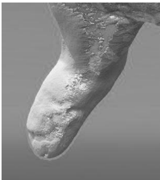
Рис. 2. Пример ЭГМ с дефектом разрыва поверхности модели Fig. 2. Example of an EGM with a model surface rupture defect
