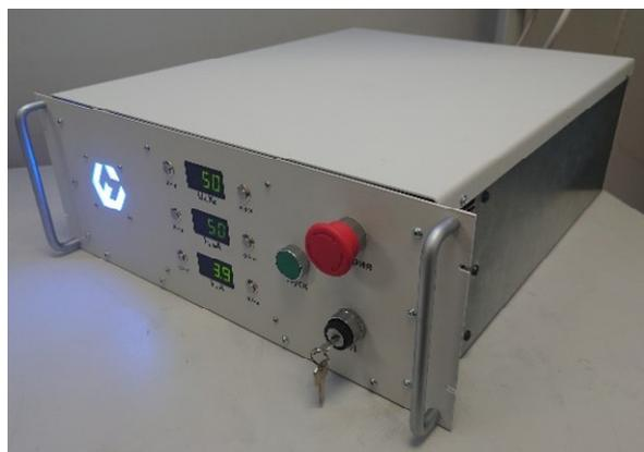
Рис. 5. Высоковольтный источник питания «СтабИст-50»
