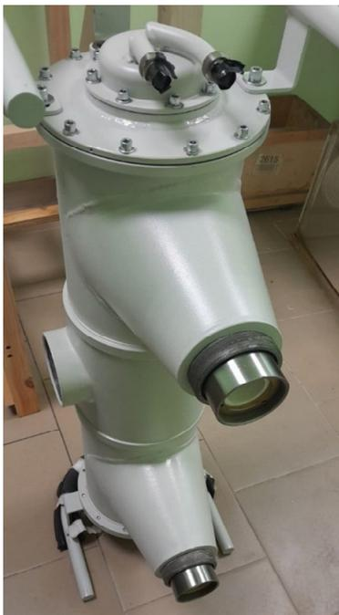
Рис. 7. Излучатель СКРА на основе отечественной металлостеклянной рентгеновской трубки 1.5БПК14-300 с дуополярным питанием и заземленной средней точкой
