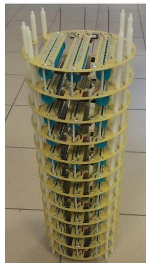
Рис. 6. Колонна умножителя СКРА на напряжение 150 кВ
