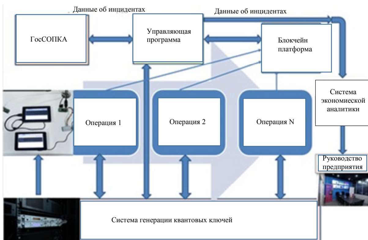
Рис. 1. Архитектура системы мониторинга на основе квантового блокчейна Fig. 1. Quantum block chain-based monitoring system architecture
