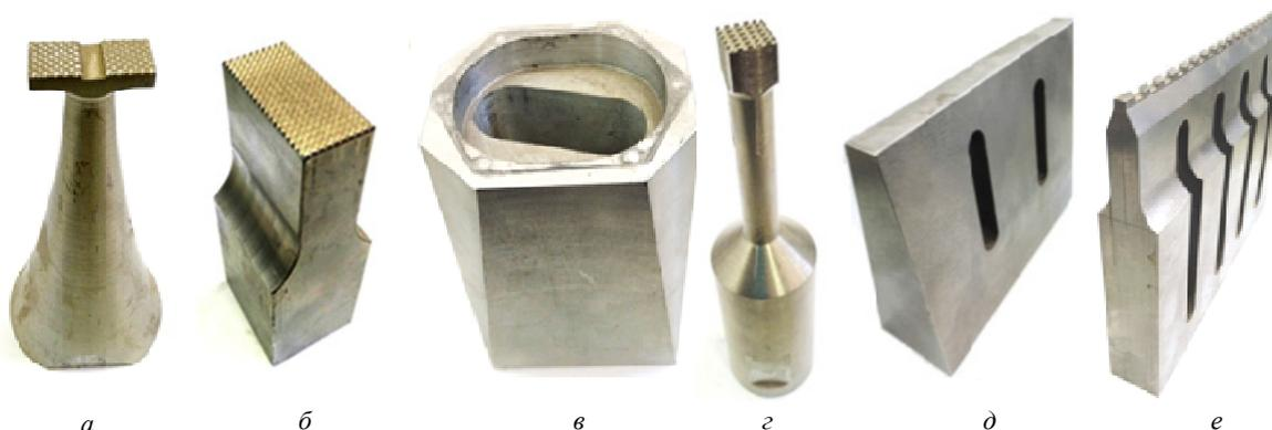
Рис. 9. Внешний вид концентраторов для ультразвукового оборудования различного назначения: а – экспоненциальный концентратор; б – прямоугольный ступенчатый концентратор; в – многоугольный конусный концентратор; з – круглый ступенчатый концентратор; д – прямоугольный конусный концентратор с отверстиями; е – концентратор ножевого типа
