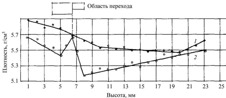
Рис. 15. Распределение плотности вдоль высоты спеченной заготовки [40]: 1 – УЗФ, амплитуда колебаний 10 мкм; 2 – статическое прессование; давление прессования  $P = 400$  МПа, толщина стенки  $s = 2$  мм
