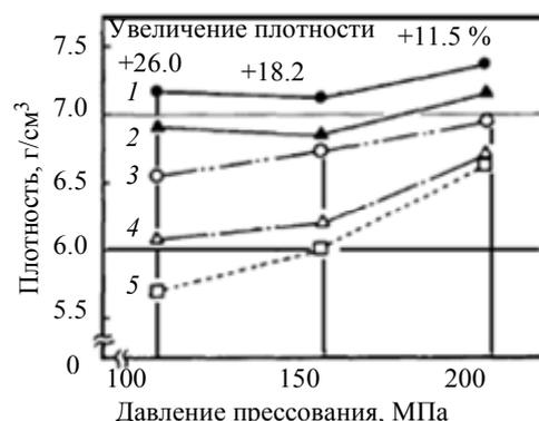
Рис. 16. Зависимость плотности образцов из медного порошка (масса порошка 7 г) от статического давления прессования [46]: 1 – радиальные колебания матрицы с амплитудой 3.5 мкм, продольные колебания пуансонов с частотами 27 и 20 кГц; 2 – продольные колебания пуансонов с частотами 27 и 20 кГц; 3 – продольные колебания пуансонов с частотой 20 кГц и амплитудой 8.7 мкм; 4 – продольные колебания пуансонов с частотой 27 кГц и амплитудой 4.75 мкм; 5 – без колебаний
