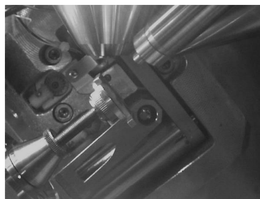
Рис. 3. Расположение образца в камере микроскопа под углом 52° к электронному пучку Fig. 3. Position of the sample in the microscope chamber at an angle of 52° to the electron beam
