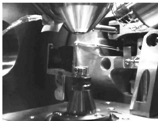
Рис. 1. Расположение образца в камере микроскопа под прямым углом к электронному пучку Fig. 1. Position of the sample in the microscope chamber at right angles to the electron beam
