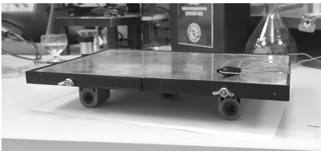
Рис. 2. Рабочая поверхность установки для автоматической обработки коронным разрядом на основе заземленного электрода из алюминия
