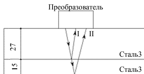
Рис. 8. Схема проведения измерений эхо-методом Fig. 8. Scheme of carrying out measurements by the echo method
