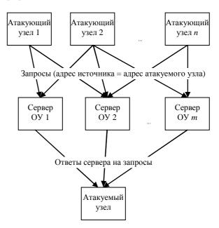
Отражение трафика достигается отправкой на определенные серверы (на рисунке обозначены как серверы ОУ) запроса, где IP-адреса источника подменяются на IP-адрес жертвы. В качестве таких серверов, в зависимости от типа реализуемой атаки, могут использоваться как крупные серверы, такие, как DNS-серверы, NTP-серверы, так и
